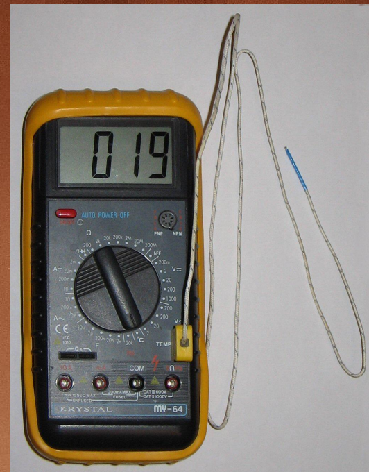
Цифровий мультиметр у режимі вимірювання температури з використанням термопары
