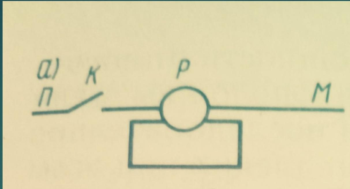
Короткозамкнутая обмотка-при размыкании цепи индуцируется ЭДС и протекает ток создающий магнитный поток, совпадающий по направлению с исчезающим рабочим магнитным потоком, обеспечивая замедление на отпускания якоря.
