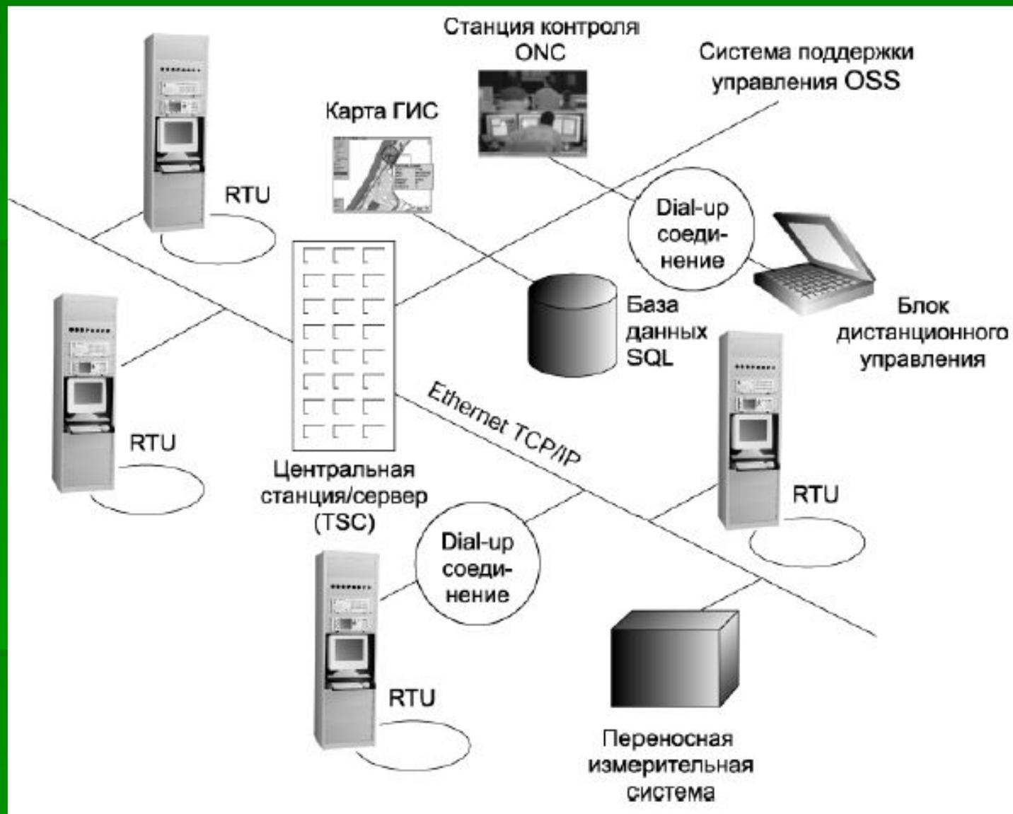
RTU (Remote Test Unit) - блок дистанционного тестирования
