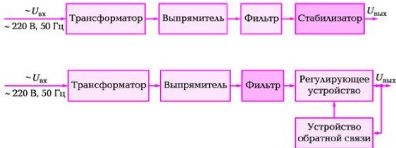
Рис. 3.2. Структурная схема ВИП с регулированием со стороны постоянного напряжения
