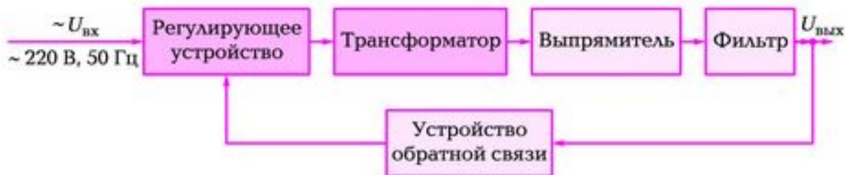
Рис. 3.3. Структурная схема ВИП с регулированием со стороны переменного напряжения
