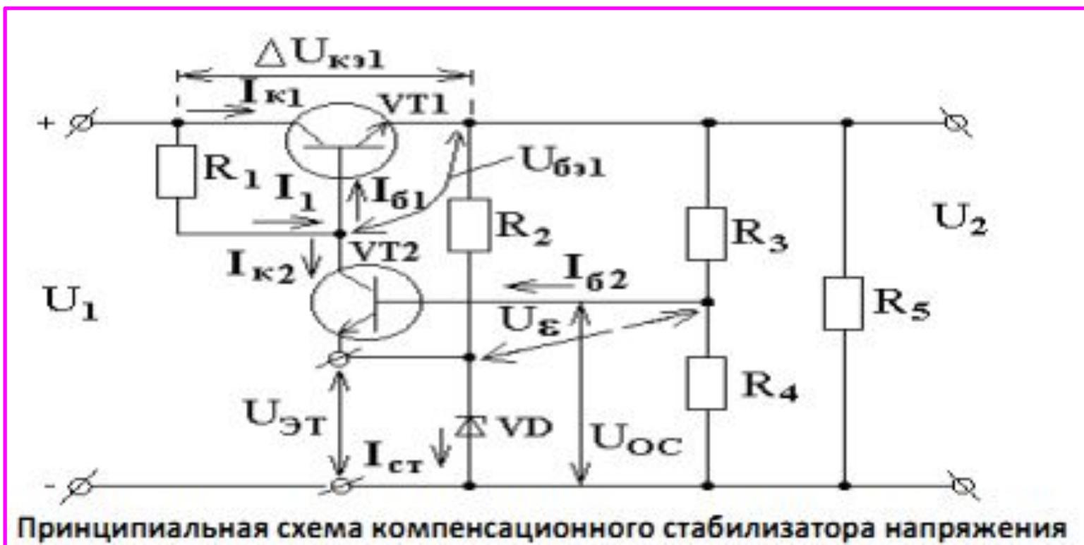
В компенсационном стабилизаторе непрерывного действия регулирующий транзистор работает в активном режиме!
