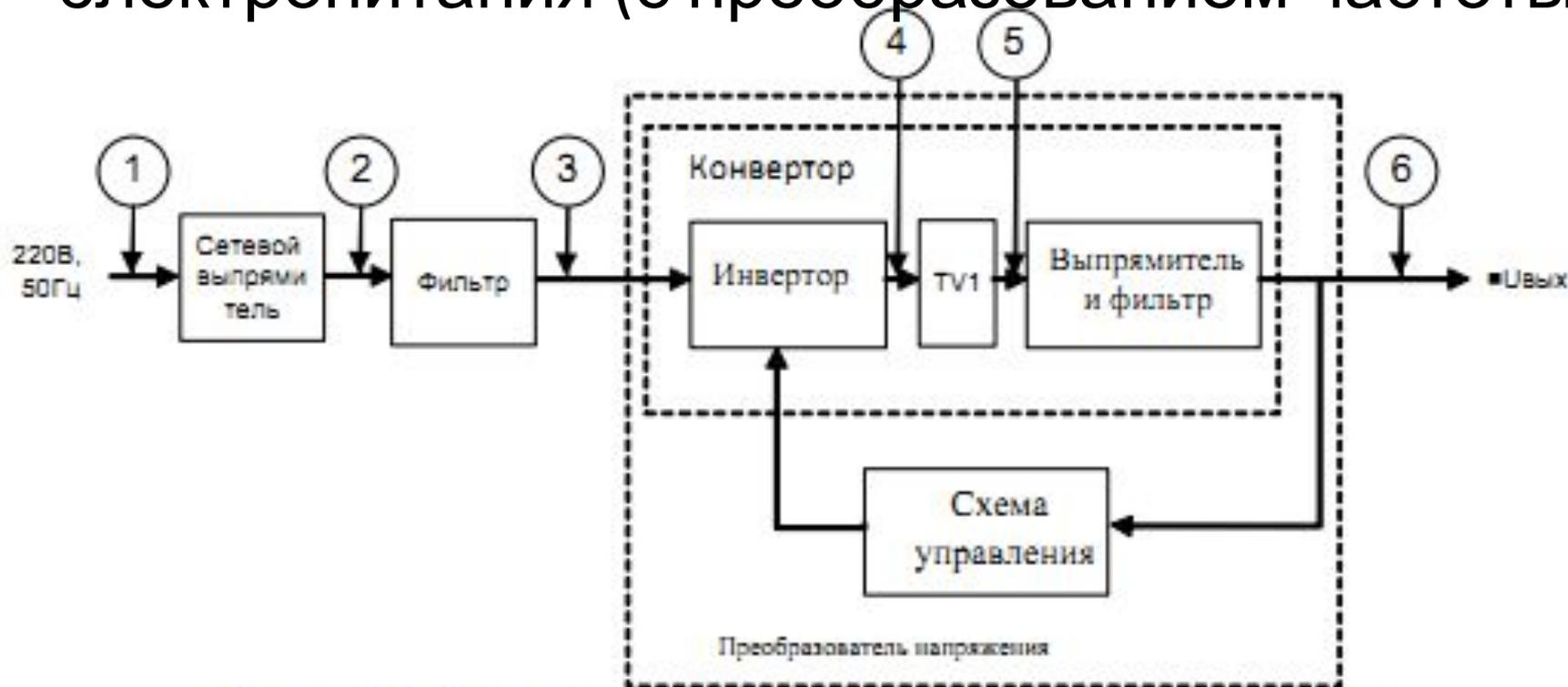
Рисунок 11 - Структурная схема ВИП с преобразованием частоты
