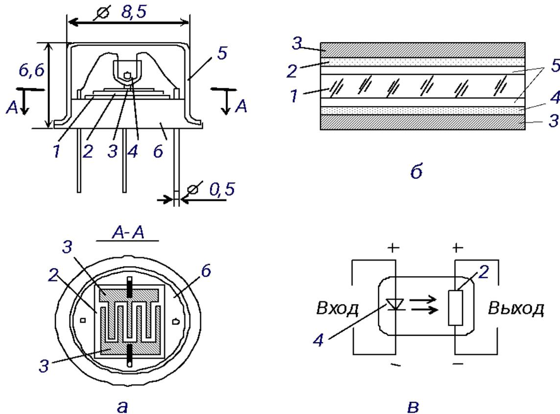
Рис. 7.18. Устройство резисторных оптронов
