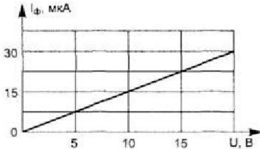
Рис.2 Вольт-амперная характеристика фоторезистора.
