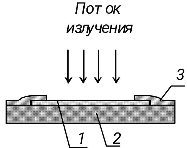
Рис. 7.15. Принципиальное устройство фоторезистора
