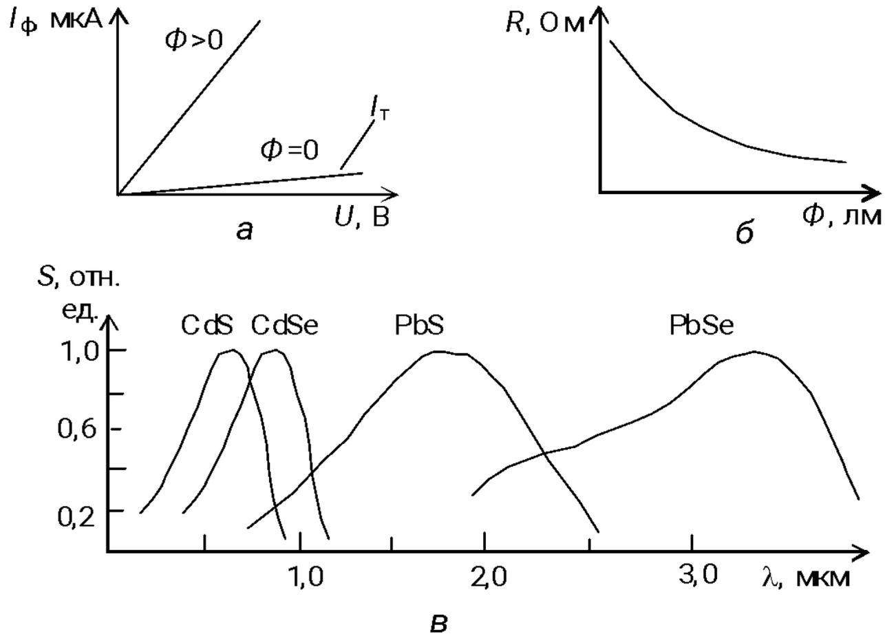
Рис. 7.16. Характеристики фоторезисторов: а – вольтамперные характеристики; б – функциональная характеристика  $R = f(\Phi)$ ; в – спектральные характеристики различных фоточувствительных элементов
