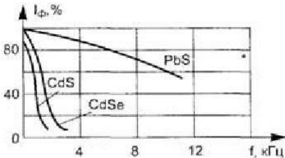
Рис.5 Частотные характеристики фоторезистора.
