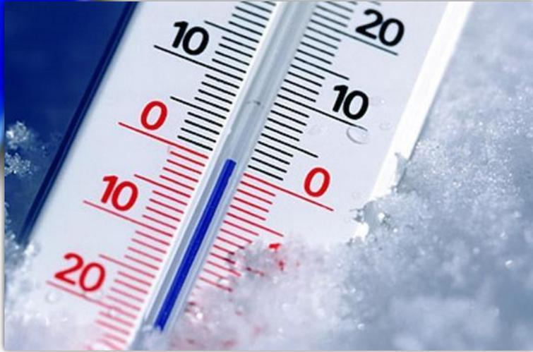
2. Снятие показаний с термометра надо производить спустя некоторое время, в течение которого он примет температуру среды.
