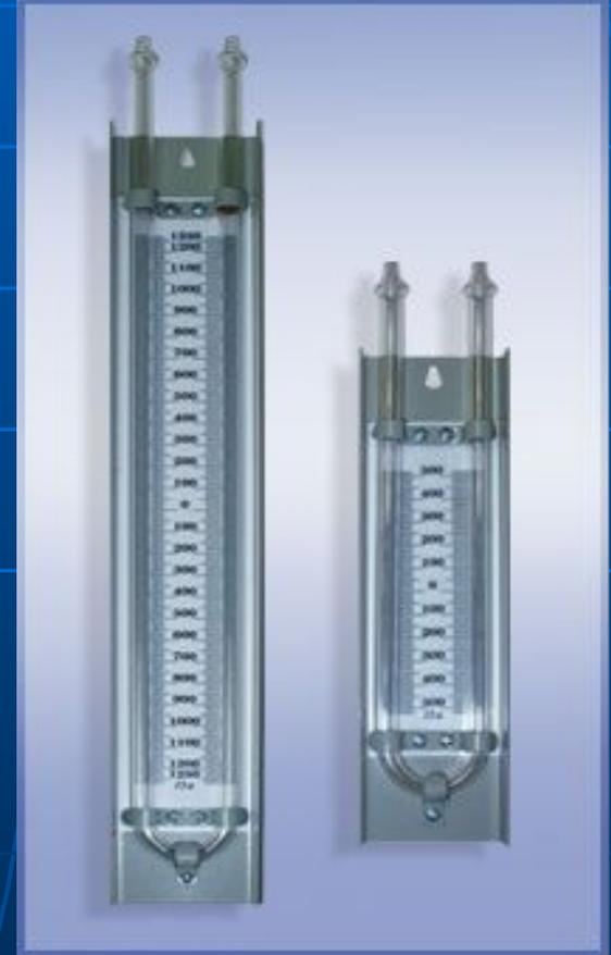
Шкала приборов представляет собой прямоугольную пластину, на которой нанесена равномерная шкала, отградуированная в мм.
