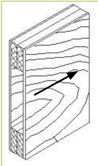
Направление волокон наружного шпона фанеры
