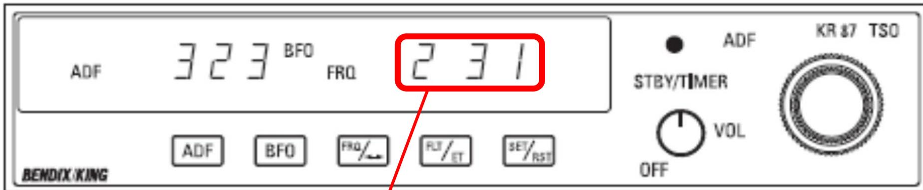
**Табло для отображения резервной частоты и таймера (STBY/TIMER)**
