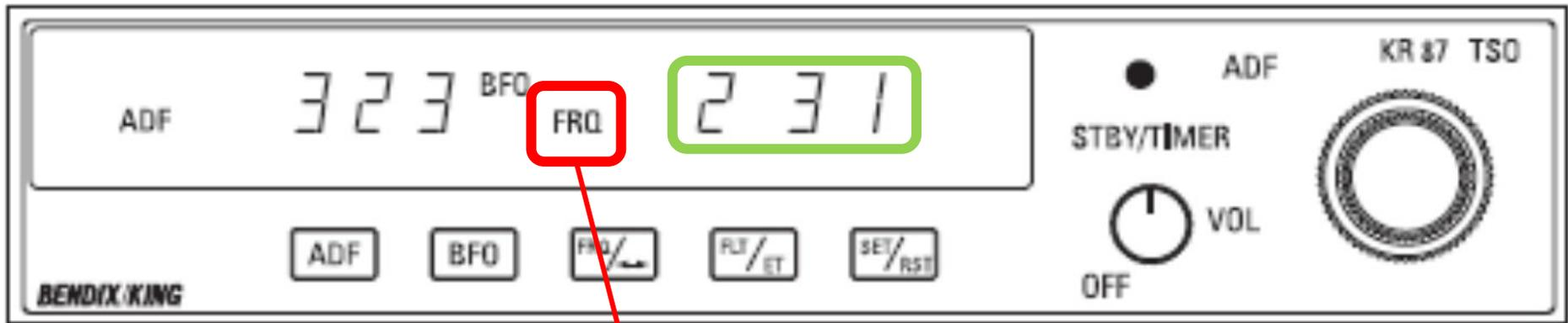
**Индикация того, что в правом окне отображается значение резервной частоты**
