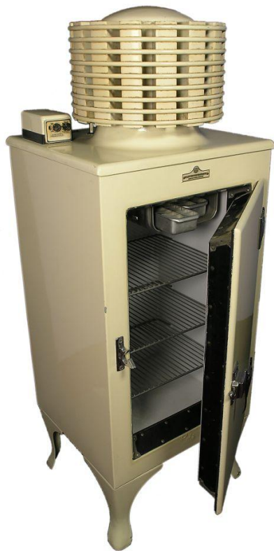
Ранний электрический холодильник, с цилиндрическим теплообменником сверху. Из коллекции музея Thinktank (Англия)
