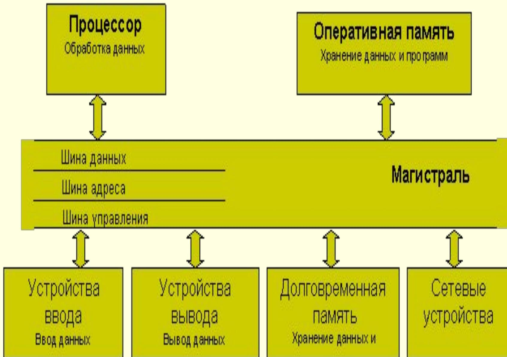
В основу современных персональных компьютеров положен магистрально-модульный принцип. Модульный принцип позволяет комплектовать нужную конфигурацию и производить необходимую модернизацию. Модульный принцип опирается на шинный принцип обмена информацией между модулями. Системная шина или магистраль компьютера включает в себя несколько шин различного назначения. Магистраль включает в себя три много разрядные шины:
