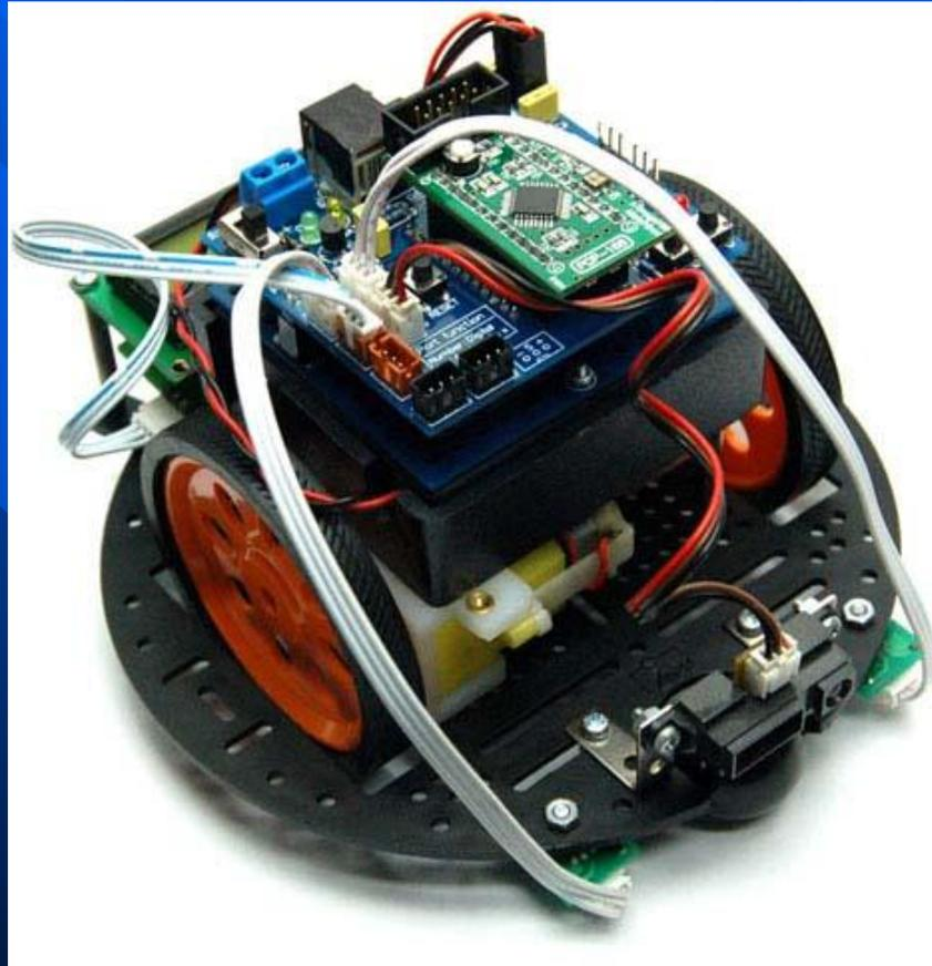
Робот с дифференциальным приводом – iE-ROBOT.
