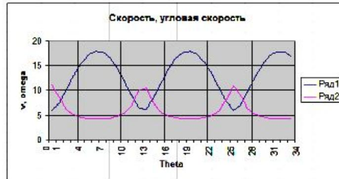
Рис. 26: Скорость и угловая скорость робота на эпитрохоиде.
