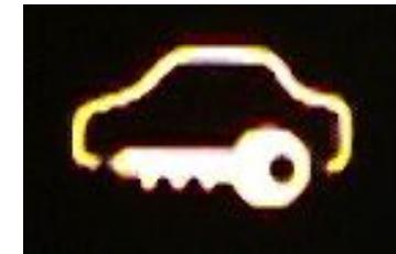
Лампа загорится при удачной проверке до определения минимальных оборотов двигателя для работы ECM (начало заводки автомобиля).
