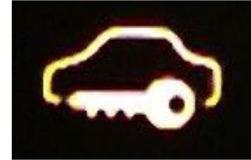
Лампа загорится при удачной проверке до определения минимальных оборотов двигателя для работы ЕСМ (начало заводки автомобиля).
