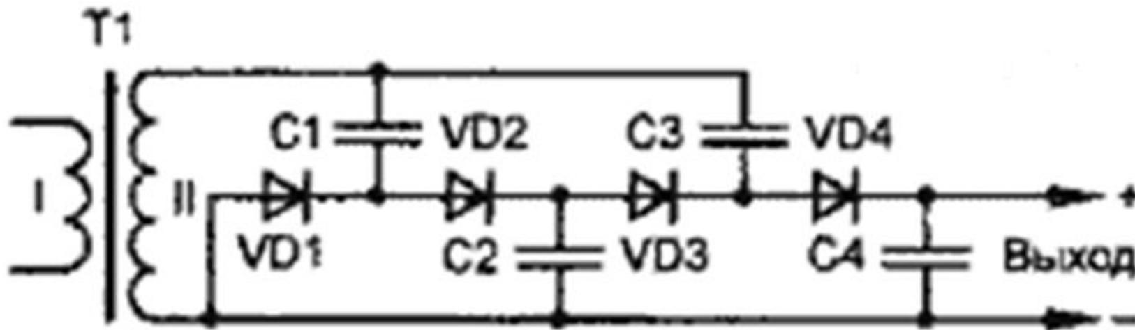
**Параллельные умножители** напряжения, для которых требуется меньшая емкость конденсатора на ступень умножения.
