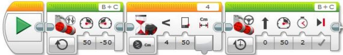
Усовершенствуем нашего «Любопытного робота», после обнаружения препятствия робот едет к нему не в течении двух секунд а подъезжает на расстояние 10 см
