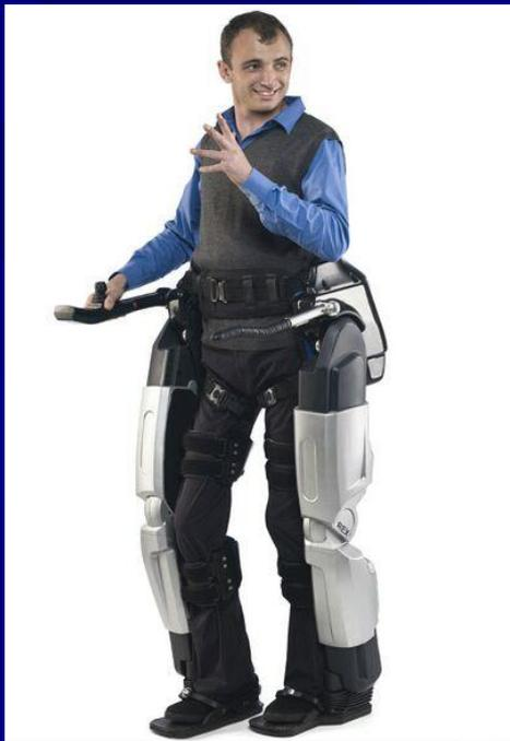
Компания [Rex Bionics](#) (Новая Зеландия) создала экзоскелет Rex (сокращение от Robotic Exoskeleton) в расчёте на то, что он дополнит привычные инвалидные коляски: машина помогает ходить человеку, не способному самостоятельно даже стоять на ногах.
