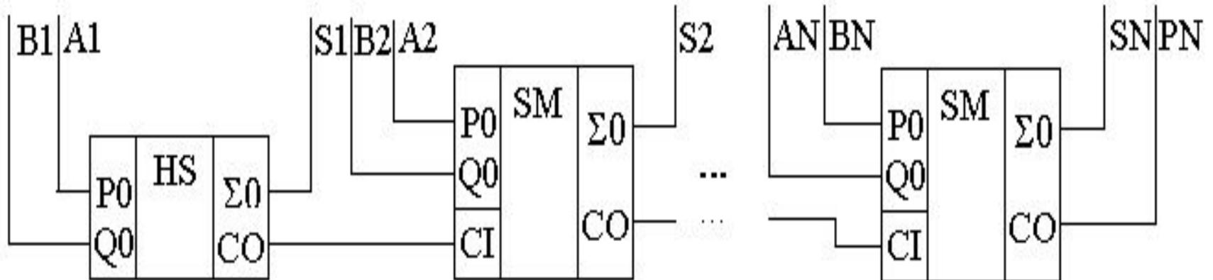
При большом количестве разрядов длительность суммирования оказывается недопустимо большой. Увеличение быстродействия достигается за счет одновременного (параллельного) формирования сигнала переноса во всех разрядах.
