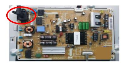
4. Произвести измерение на R9816. После установки резистора R9819, значение должно составлять ->  $0.783V\pm2\%$  ( $0.767\sim0.798V$ )
