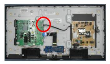
Регулировку блока питания проводить при отключенном кабеле питания на основную плату!!!
