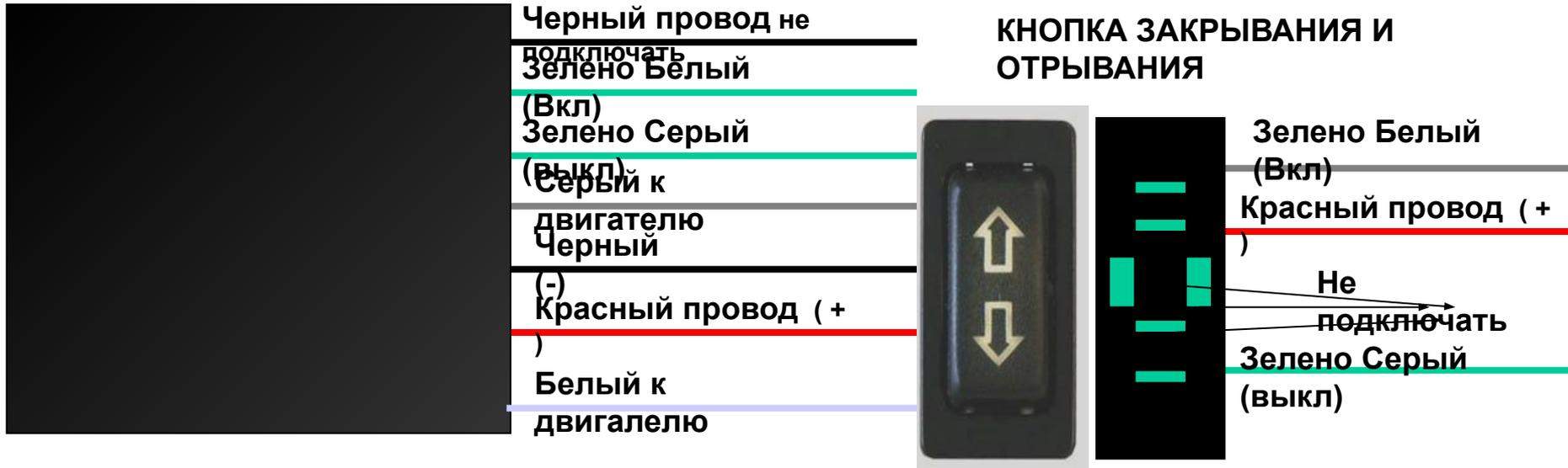
Провода (+) и (-), провода которые обозначены на схеме синим цветом, а также питание от бортовой сети необходимо протянуть кабелем с сечением не менее 2,5мм.
