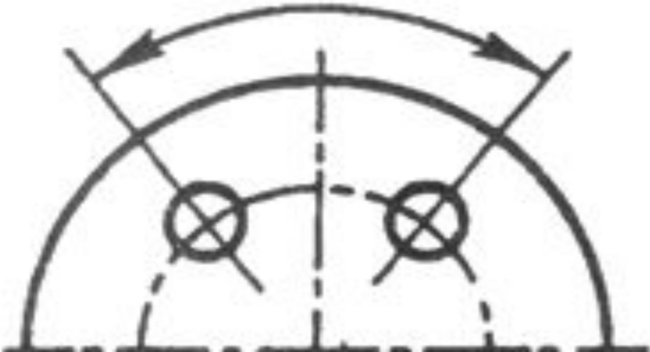
При различных наклонах размерных линий размерные числа располагают так как показано на рисунке.
