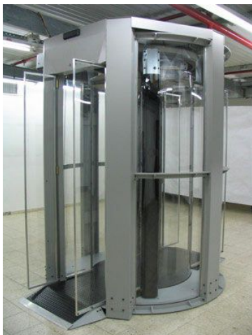
Радиолокационный сканирующий портал, работающий в терагерцевом диапазоне электромагнитного спектра
