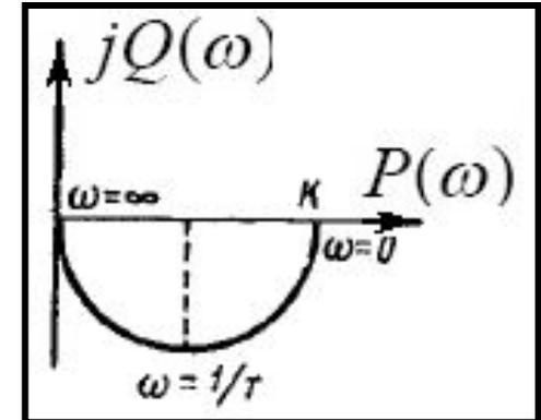
$$W(j\omega) = \frac{k}{Tj\omega + 1} = \frac{k(1 - jT\omega)}{(1 + jT\omega)(1 - jT\omega)}$$
