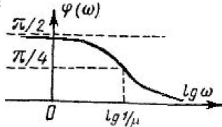
$$L(\omega) = 20 \lg |k| + 20 \lg \omega - 20 \lg \sqrt{1 + (\mu\omega)^2}$$
