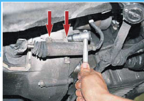
Головкой «на 12» отворачиваем два болта и снимаем рабочий цилиндр с картера сцепления.
