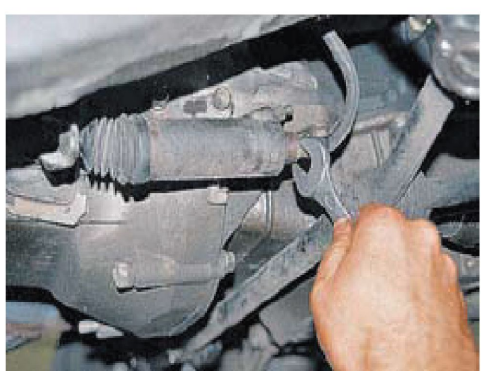
Ключом «на 17» ослабляем затяжку наконечника шланга.
