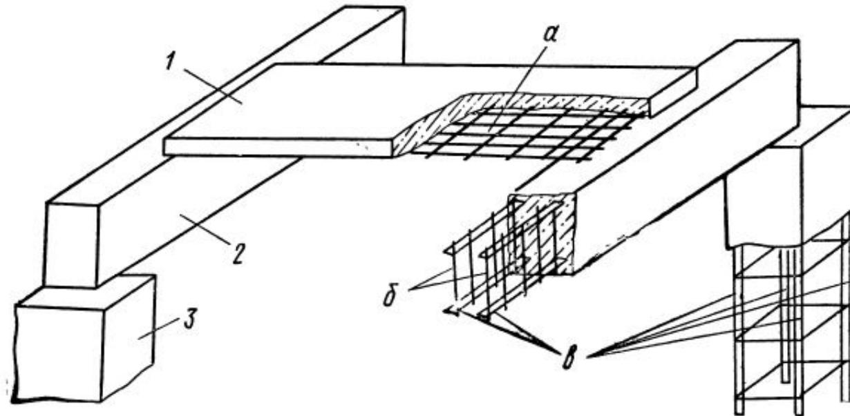
**Рис. 1.16. Арматура железобетонных элементов**
