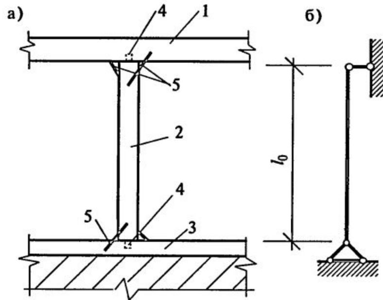
Соединение деревянной стойки с прогоном:
