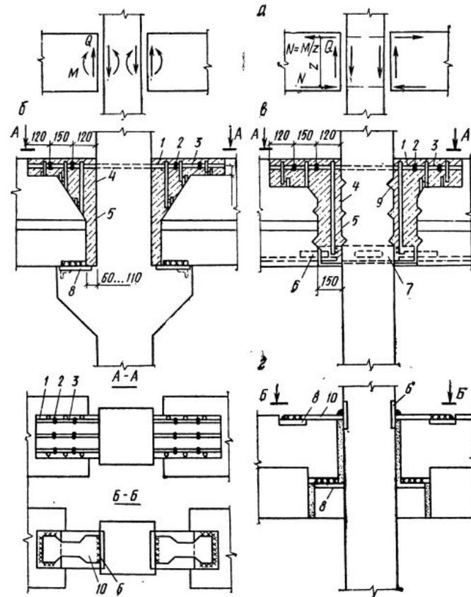
**Рис. 11.16. Конструкции стыков сборного ригеля с колонной**
