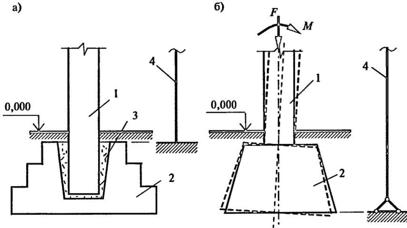
*Заделка железобетонных колонн в фундаментах:*
