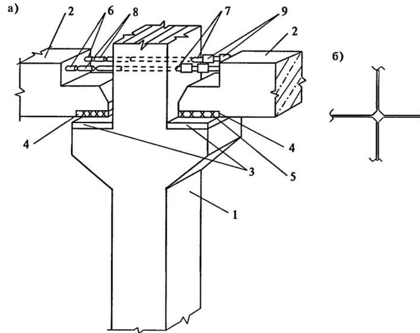
**Жесткое соединение железобетонного ригеля с колонной:**
