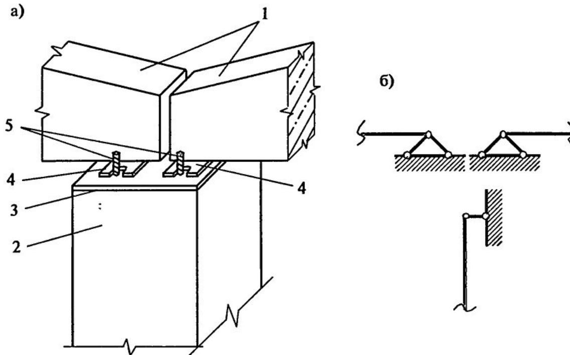
*Шарнирное опирание стропильной железобетонной балки на колонну: а) схема опирания; б) расчетная схема опирания балок на колонну и колонны на балки; 1 — балки; 2 — колонна; 3 — опорная плита колонны; 4 — закладные детали балки; 5 — болты (гайки не показаны)*
