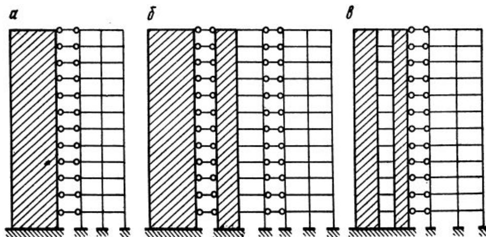
**Рис. 15.26. Расчетные схемы рамно-связевых систем с диафрагмами**
