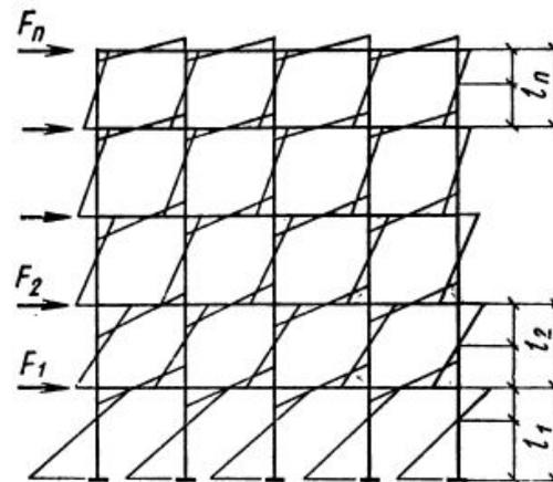
Рис. 15.15. К расчету многоэтажных рам на горизонтальные нагрузки
