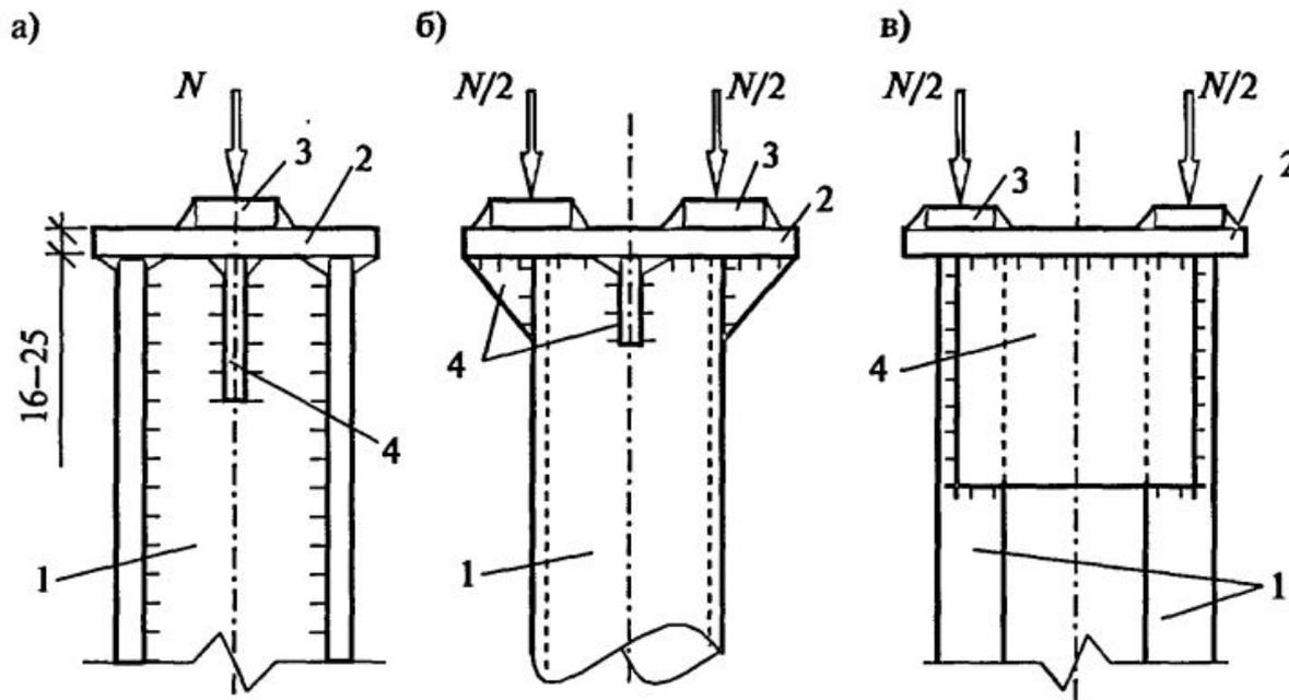
Оголовки стальных колонн с различным сечением стержней:
