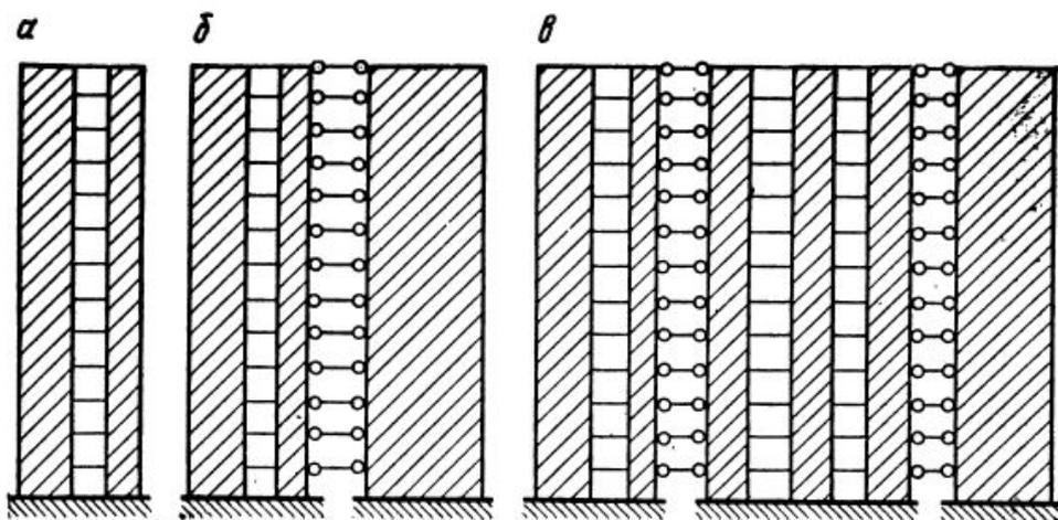
**Рис. 15.27. Расчетные схемы связевых систем**
