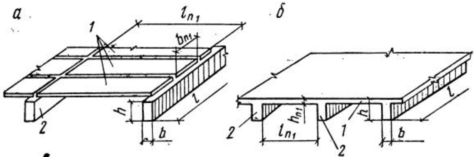
**Рис. 3.1. Схемы перекрытий из железобетонных элементов**
