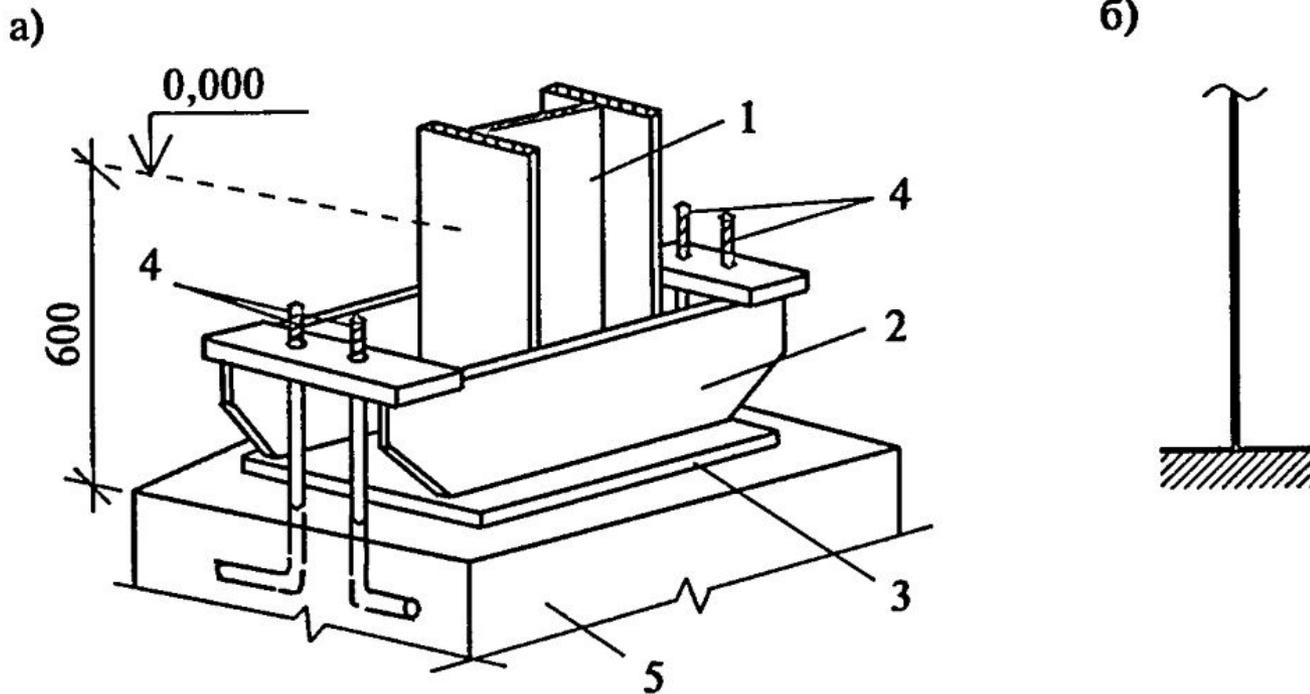
*Жесткое крепление колонны к фундаменту: а) конструктивная схема; б) расчетная схема; 1 — колонна; 2 — траверса; 3 — опорная плита базы колонны; 4 — анкерные болты (гайки, шайбы не показаны); 5 — фундамент*
