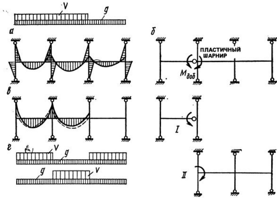
Рис. 15.14. К расчету многоэтажных рам на вертикальные нагрузки по выравненным моментам
