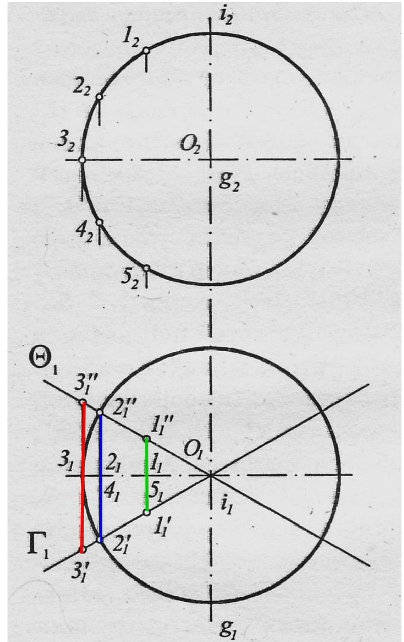
Построим развертку одной доли. Наметим ось симметрии элемента, на которой отложим длину **главного меридиана** = н.в. Для этого разделим главный меридиан на 6 равных частей.
