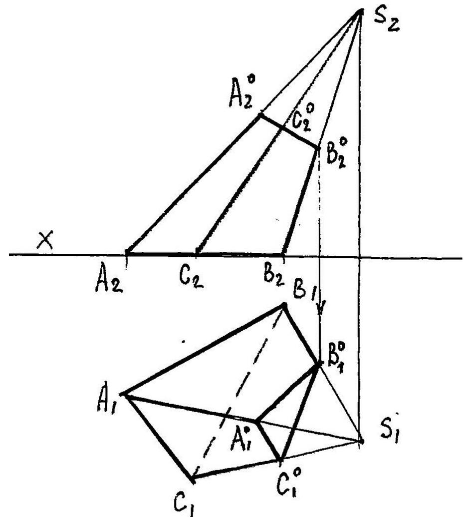
Для определения натуральных величин ребер применим метод вращения вокруг проецирующих осей. **Ось вращения  $j$**  проведем через  $(.) S$  перпендикулярно плоскости  $\Pi_1$ . Развернем ребро  $SA$  в положение, **параллельное** плоскости  $\Pi_2$  и найдем **натуральную величину  $[SA]$** . Т.к.  $(.) A^\circ$  лежит на ребре  $SA$ , она также развернется в новое положение (на  $\Pi_2$  фронтальная проекция  $A^\circ 2$  переместится на своей высоте на **Н.В.  $[SA]$**  )
