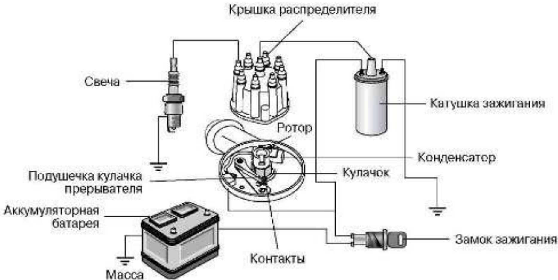
Рис. 5.8. Схема обычной неэлектронной системы зажигания
