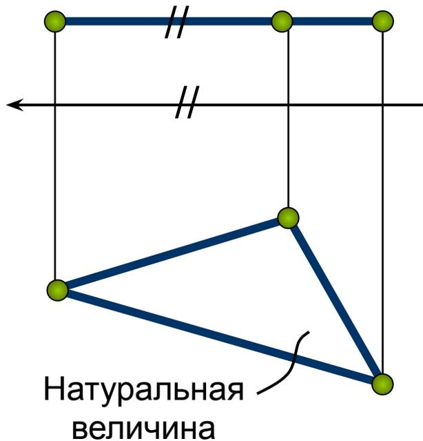
При переходе к новой системе плоскостей одну из плоскостей заменяют так, чтобы геометрический элемент занял частное положение
