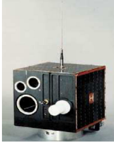
Германский микроспутник DRL-Tubsat Масса .....45 кг Разрешение ... 6 м
