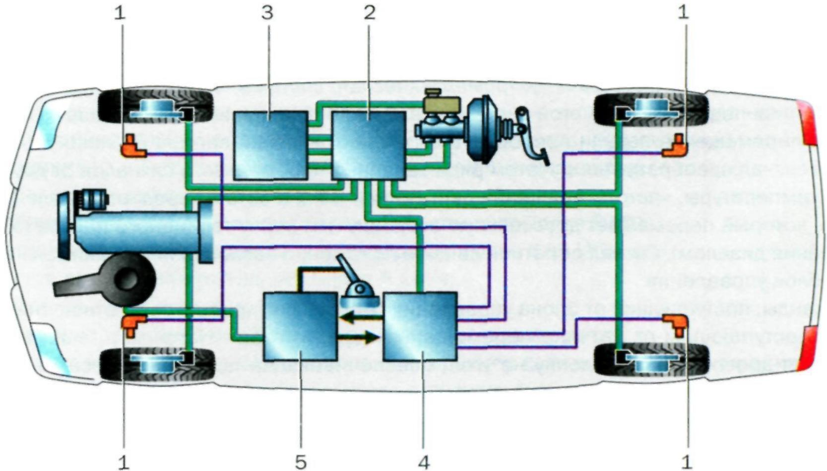
Внутри цилиндров модулятора расположены плавающие поршни с центральными клапанами. Последние соединяют входную и выходную магистрали цилиндра. Поршни управляются посредством трехпозиционных электромагнитных и двухпозиционных дросселирующих клапанов.
