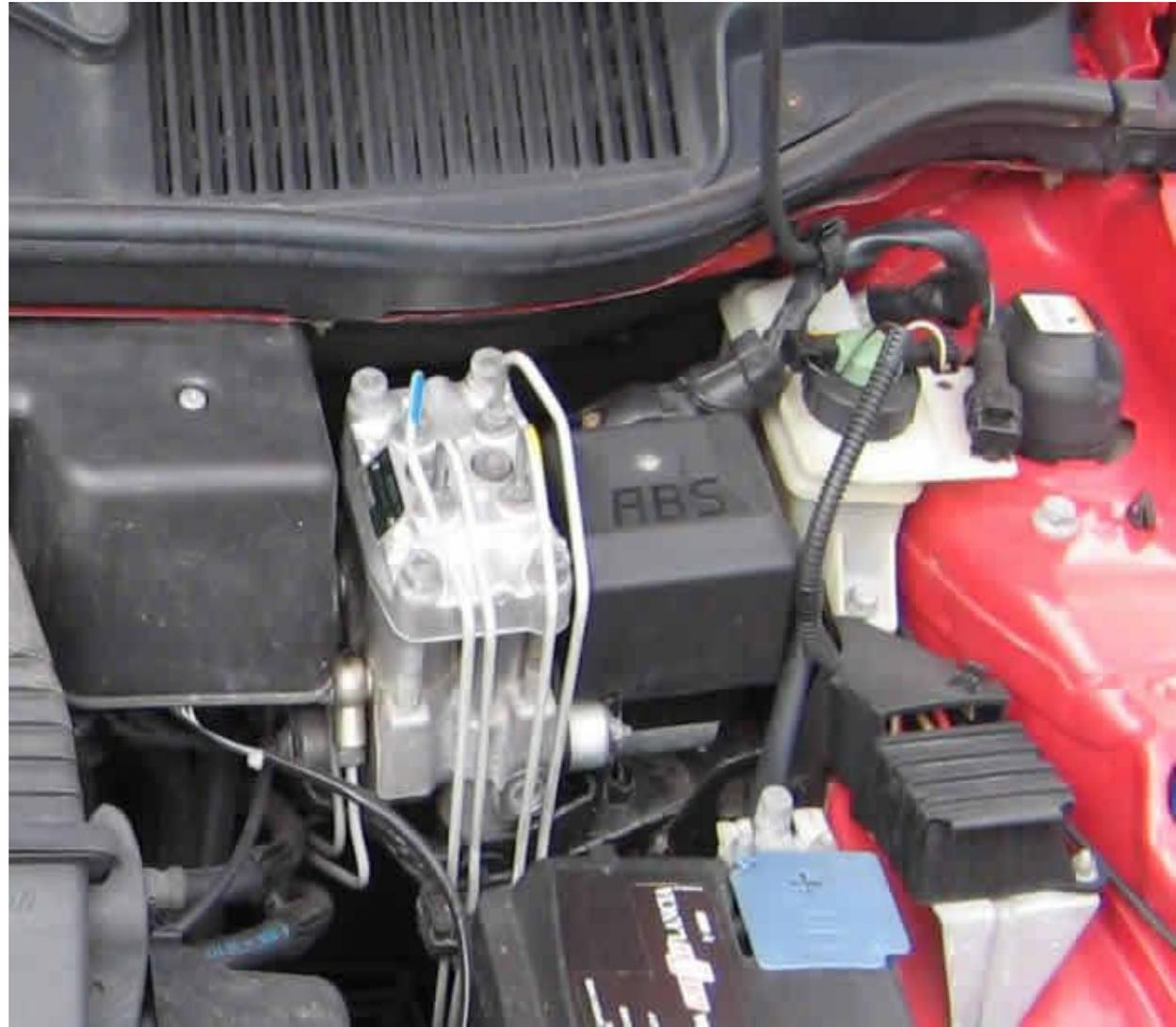
Для получения большей точности и плавности регулирования скольжения колес в тяговом режиме в ПБС изменение давления необходимо производить более медленно, чем в АБС.
