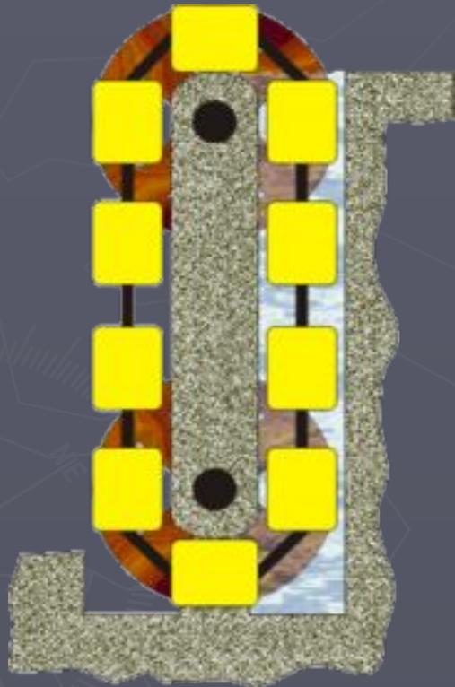
На самый нижний бак будет действовать лишь сила давления на его правую поверхность, и она будет превышать суммарную силу, действующую на остальные баки. Поэтому вся система просто прокрутится по часовой стрелке, пока не выльется вода.
