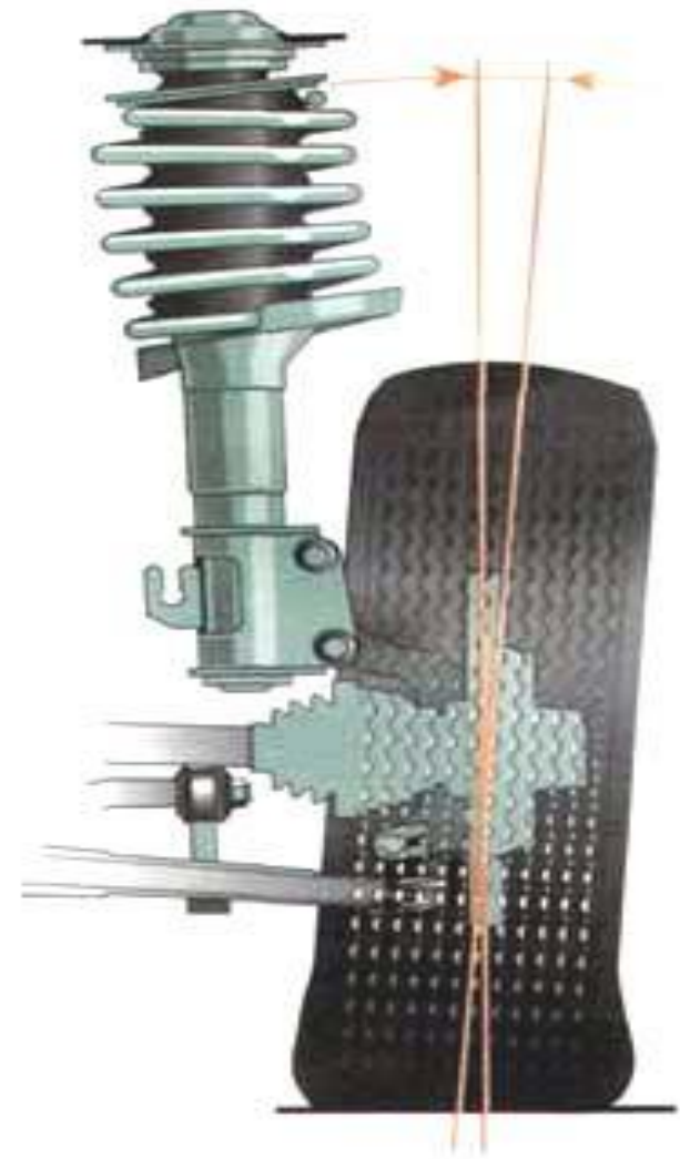
Рис. 2. Угол развала колеса.
