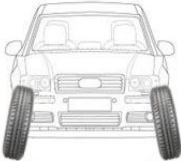
Наклон к кузову отрицательный развал колес
