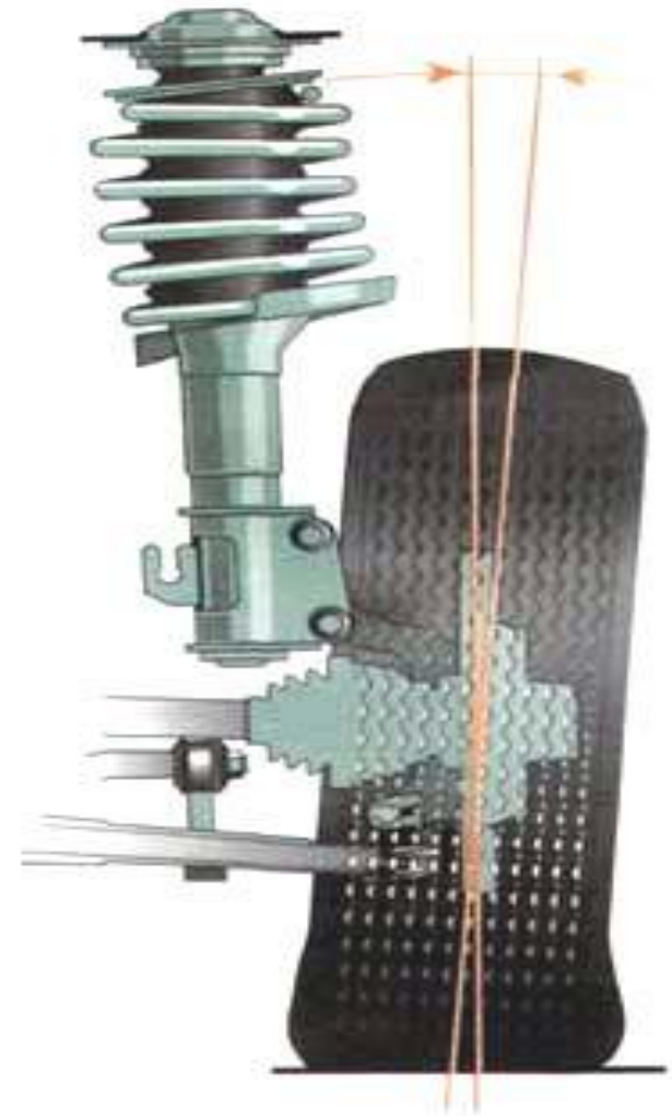
Рис. 2. Угол развала колеса.
