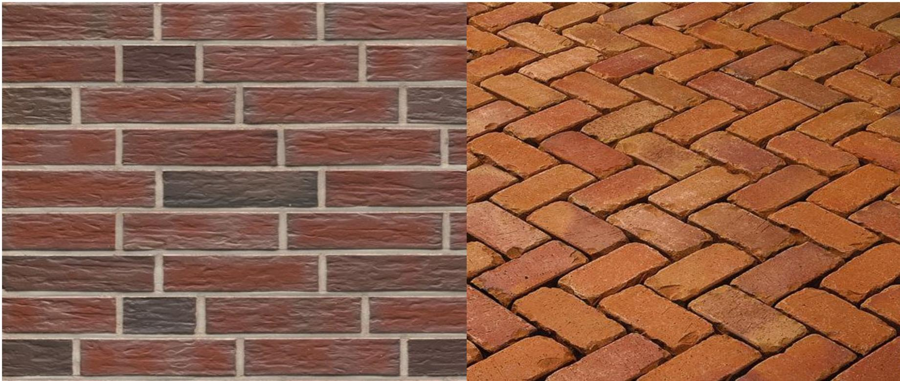
клинкерный кирпич — марки по прочности М300, М400, М500, М600, М800, М1000
