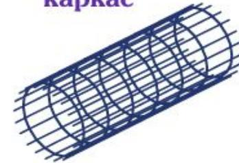
Каркас вязаный с отогнутыми стержнями
