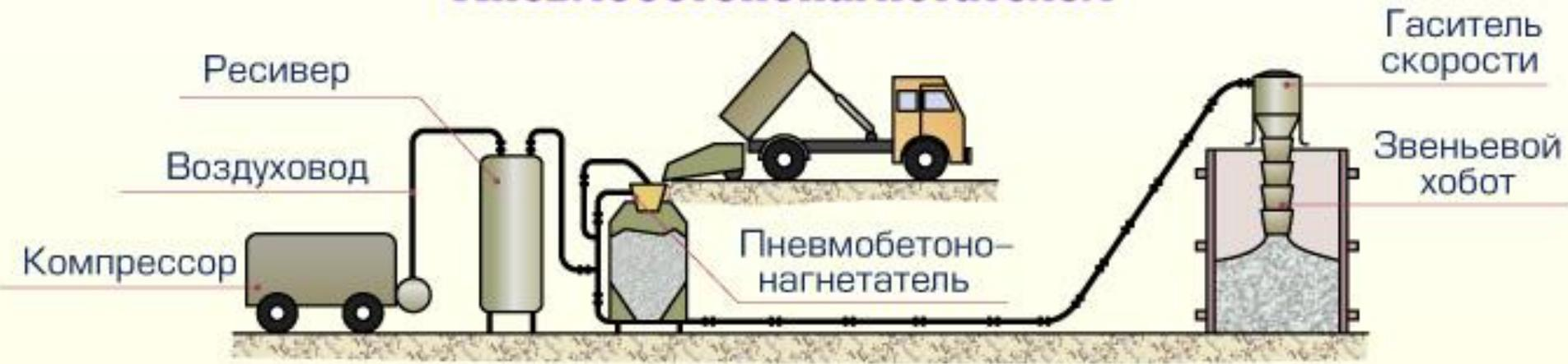
**Пневмонагнетатель** применяется для транспортирования жестких бетонных смесей (бетонные смеси с низким В/Ц, фибробетонные смеси, полистиролбетон и т.д.)
