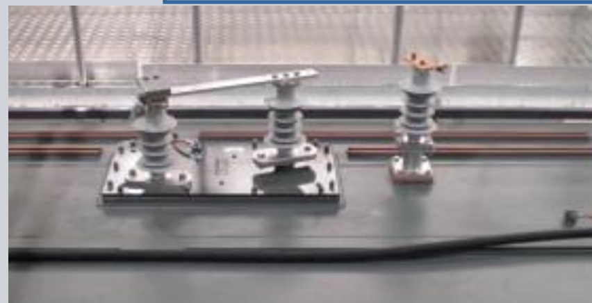
Разъединитель крышевой проводки переменного тока
