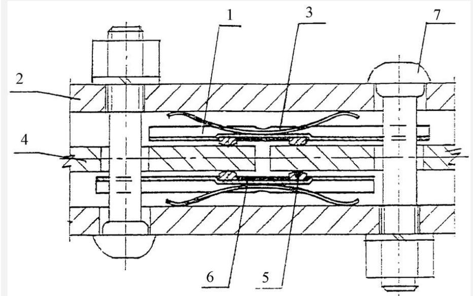
Рисунок 6 – Пружинный рельсовый соединитель:
