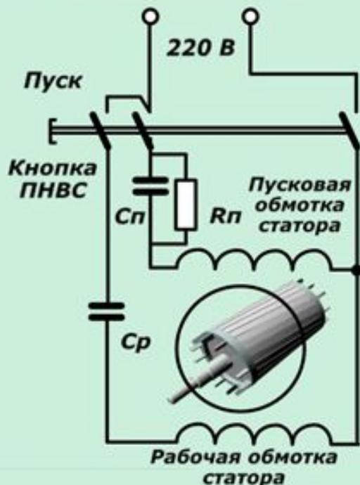
Создается наибольший крутящий момент и более высокий коэффициент мощности, чем при резистивном или индуктивном способе запуска. Он может достигать величины  $45\div 50\%$  от номинального значения. Конденсаторный запуск позволяет изменять направление вращения якоря. Для этого достаточно сменить полярность подключения пусковой или рабочей обмотки.
