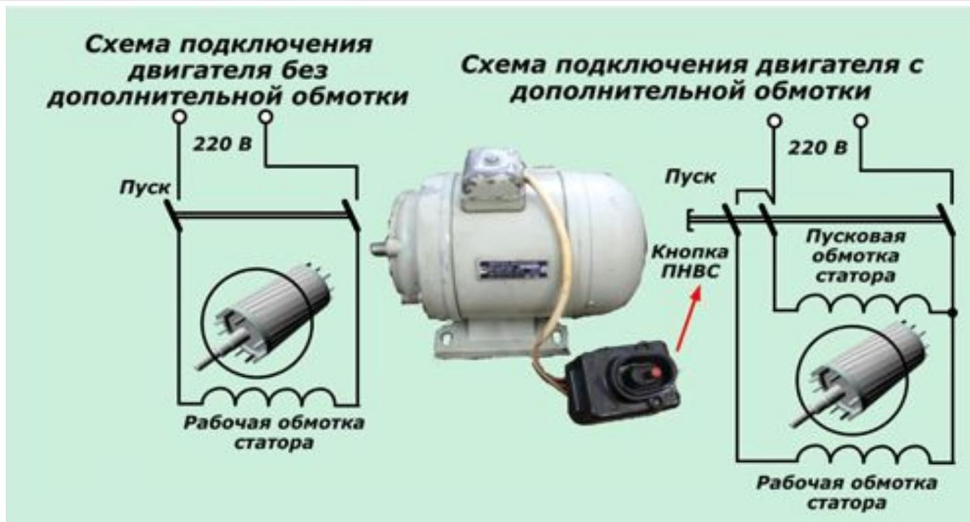
Чтобы придать начальное вращение ротору к статорной обмотке дополнительно на момент запуска подключают еще одну вспомогательную обмотку, но только сдвинутую по углу на 90 градусов. Ее выполняют более толстым проводом для пропуска больших токов, чем протекающие в рабочей.
