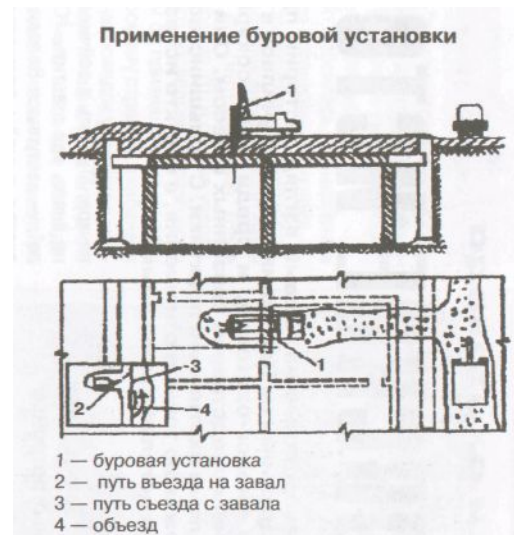
Бурение отверстия через перекрытие с расчисткой завала и подача воздуха компрессором
