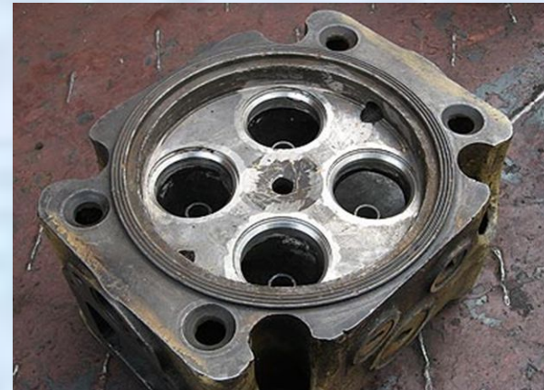
Седло головки цилиндров после восстановления.
