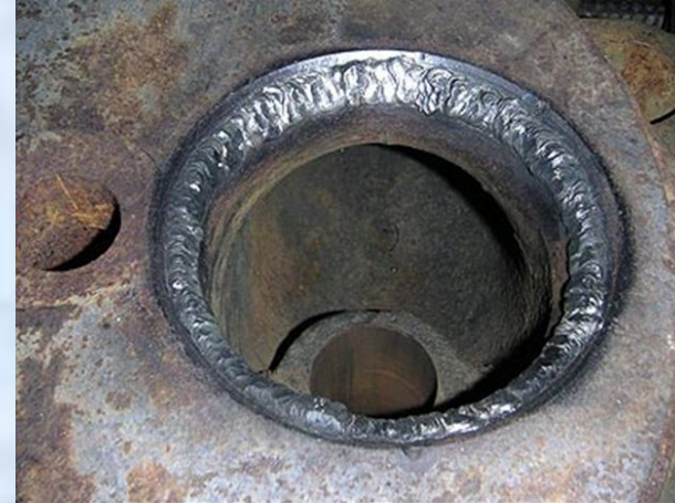
Седло головки цилиндров после восстановления.
