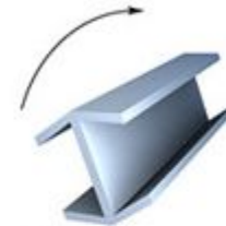
Сварка поясов со стенкой балки с двух сторон (с перекантовкой)
