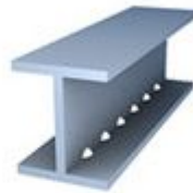
Точечная прихватка поясов к стене балки
