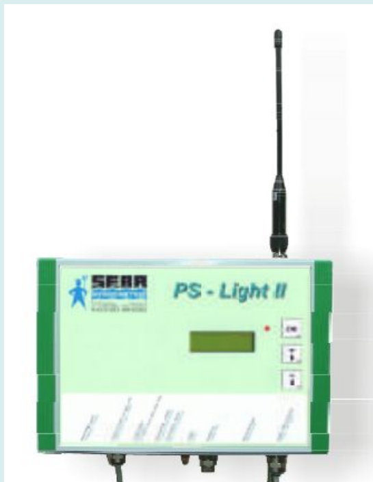
PS-Light-2 с GSM модемом и антенной
