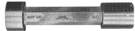
Рис. 3.12. Проходной калибр-пробка (P-IP)
