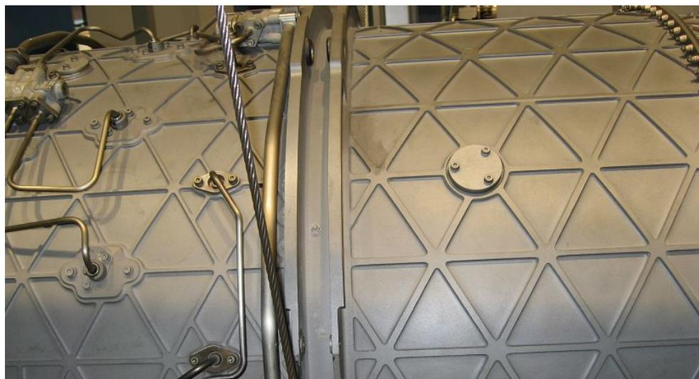
**ТАКАЯ КОНСТРУКЦИЯ ПОВЫШАЕТ ЖЕСТКОСТЬ КОРПУСА**
