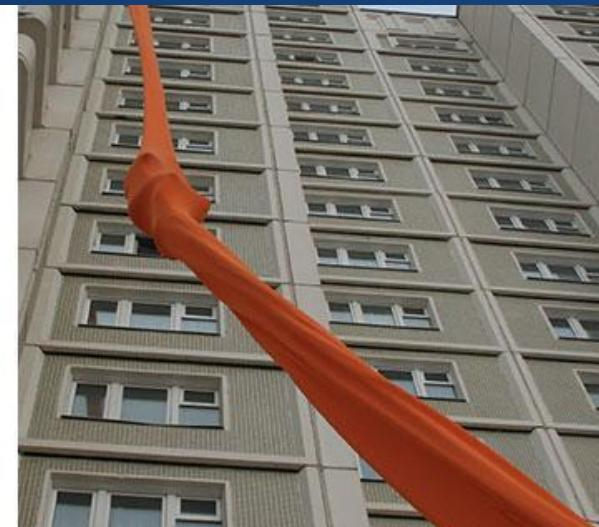
Спасательный рукав состоит из двух слоев: внутренний - прочный широкий нерастяжимый рукав; наружный - эластичный в поперечном направлении рукав. Снаружи спасательный рукав может быть защищен от воздействия теплового излучения, искр, мелких падающих предметов и т.п. кремнезёмной теплоотражательной оболочкой.
