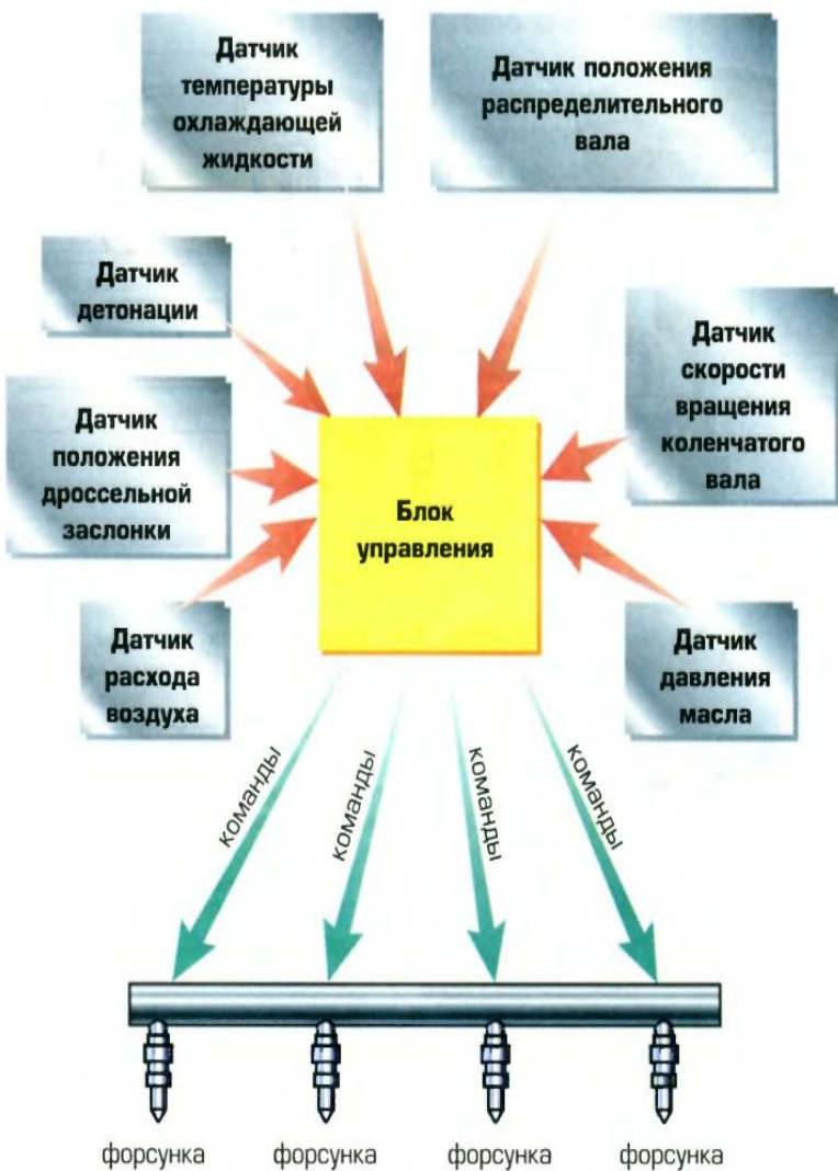
Рис. 20. Принцип работы бортового компьютера.
