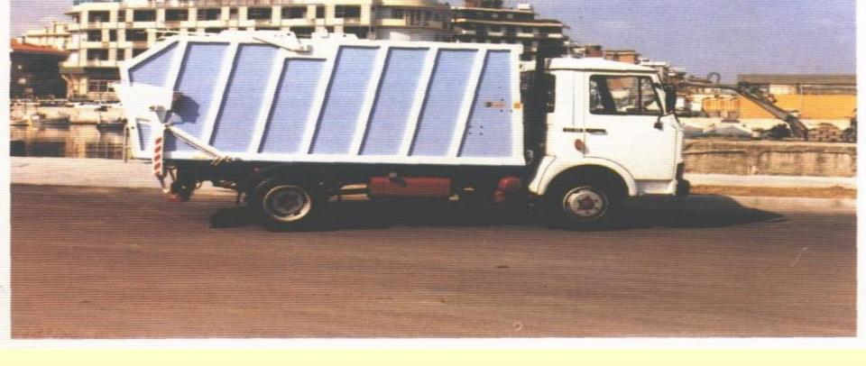
Оборудование для мини трамбовки типа KR2000 - Автомобиль-пресовщик мусора, оснащенный обычным или гидравлическим компрессионным механизмом, подъёмными мусорными баками с опрокидывателями и механической лопаткой, обеспечивающей сбор с прессованием. Устанавливается на транспортных средствах малой и средней грузоподъёмности от 1,5 до 11-
