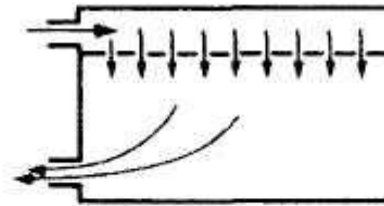
Подача свежего воздуха через перфорированный потолок
