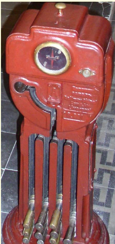
Электромеханический замыкающий жезловый аппарат.
