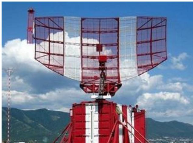
Антенная система формирует приемо-передающую диаграмму ПК нижних углов (НУ) и приемную диаграмму верхних углов (ВУ). Нижний луч используется для работы по целям, находящимся на больших дальностях под малыми углами места, верхний луч позволяет на малых дальностях уменьшить чувствительность радиолокатора к отражениям от местных предметов и позволяет увеличить зону обзора в вертикальной плоскости.
