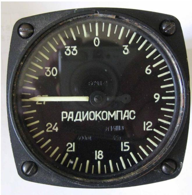
Наиболее распространенным типом самолётных радиопеленгаторов является так называемый **радиокompас** - устройство, с помощью которого можно производить отсчёт углов сразу же после настройки на принимаемую радиостанцию.
