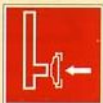
Пожарный сухотрубный стояк
