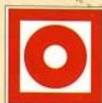
Кнопка включения установок (систем) пожарной автоматики
